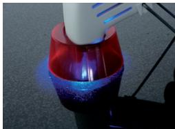
Mit AKELUX Sichtfolie/Oberflächenstrukturstempel\*\* bedecken und 60 s/cm<sup>2</sup> mit AKELUX LED Lichtstrahler\* aushärten.
