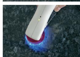
Dek af met AKELUX transparante folie/oppervlaktestructuur stempel en laat gedurende 60 s/cm<sup>2</sup> uitharden met de AKELUX LED lichtstraler\*.
