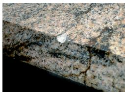
Cassure ou abattage d'une arête dans la pierre naturelle et artificielle (comme le marbre, le granit, le composite de quartz) ainsi que la céramique (p.ex. plan de travail de cuisine, appui de fenêtre, salle de bain, revêtement du sol, marche d'escalier).
