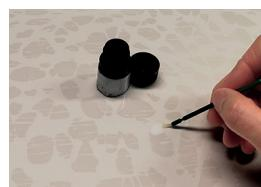
Bij keramiek kan de kleur van de scherven (body) sterk afwijken van de decor/toplaag kleur. Als dit het geval is dien je deze schade met een zeer dunne laag AKELUX Opaquing Agent te dekken. Deze laag dient vervolgens 60 seconden uitgeharden te worden met de AKELUX LED lichtstraler\*.
