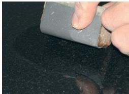
AKELUX Silikon-Schleifleinen auf den AKELUX Schleif- und Polierblock legen und die Schadstelle in der Reihenfolge 2400-3200-4000 nass feinschleifen. Bei Verwendung eines Oberflächenstrukturstempels entfällt dieser Schritt.
