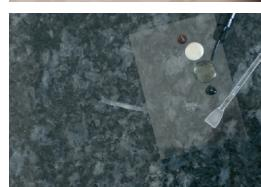
AKELUX Filler transparant vloeibaar mengen met verschillende kleuren AKELUX Fillers (max. 50% kleur) en aanpassen aan de kleur van het object. Indien nodig vullen met AKELUX Structuur.
