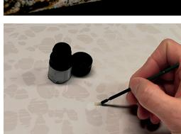
Keramische Scherben, die sich stark vom Decor unterscheiden, können nun mit einer sehr dünnen Schicht AKELUX Opaquing Agent überdeckt werden. Diese Schicht muss im Anschluss 60 Sekunden mit dem AKELUX LED-Lichtstrahler\* ausgehärtet werden.
