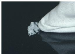
AKELUX Polerpaste auf die Reparaturstelle auftragen. Manuell mit AKELUX Poliertuch und der Filzseite des AKELUX Schleif- und Polierblocks oder maschinell aufpolieren (z.B. Dremel mit Filzscheibe).
