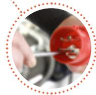
**Drehstromstecker** mit Phasenwender: die richtige Motor-drehrichtung wählen.
