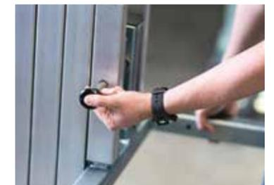
Montage und Fixierung der Lastgabel mittels Kugelsperbolzen
