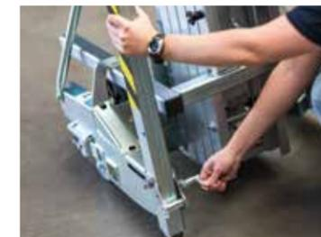
Öffnen und Fixieren der Vorderteile mittels Federriegel
