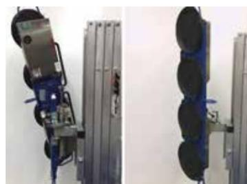
Elektrische Universal-Glassauganlage für Senkrecht- oder Überkopfmontage
