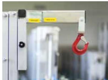
Lasthaken / Adapter mit Wirbelhaken für Glassauganlage
