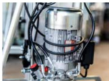
Elektro-hydraulischer Antrieb (LH)
