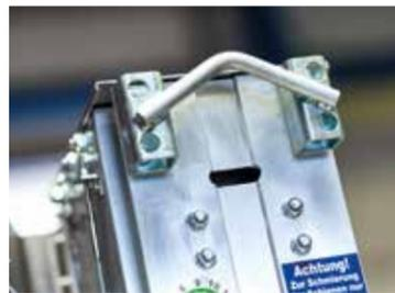
Kranöse am Mast für einen sicheren Transport
