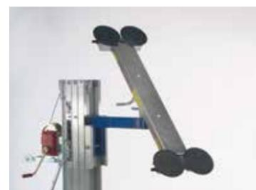
manuelle Glassauganlage für Überkopfmontage
