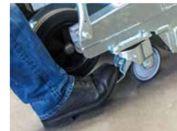
Fixierung der Feststellbremse an der Lenkrolle
