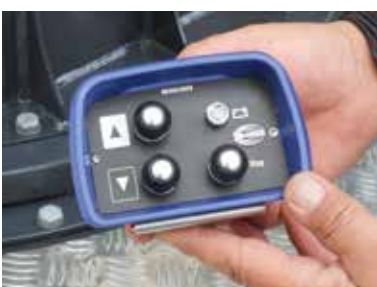
Optionale Bedienung unten über Funksteuerung
