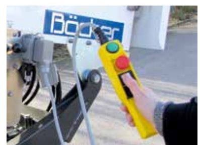
Bedienung unten über Bedienungstaster mit 4 m Kabel
