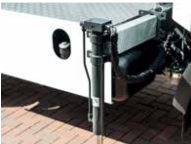
Hydraulische Stützen vorne optional ausziehbar
