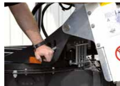
Verstellbarer Drehkranz mit mechanisch lösbarer Sperre
