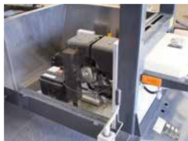
Sparsamer Honda Antriebsmotor und großer Tank
