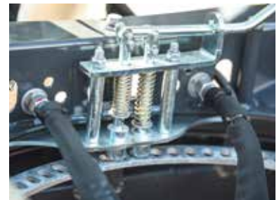
Stufenlos verstellbarer Drehkranz mit mechanisch lösbarer Sperre
