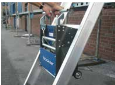
Einfaches Einhängen der Antriebseinheit
