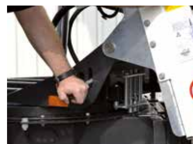
Verstellbarer Drehkranz mit mechanisch lösbarer Sperre
