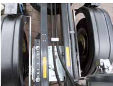
Einschiebbare Achse, Rangierbreite 0,89 m (optional)
