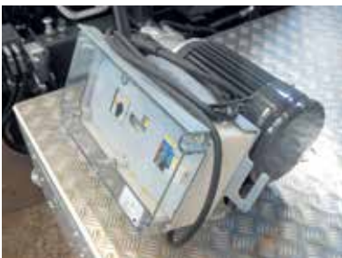
Zusätzlicher 230 Volt E-Motor (optional)
