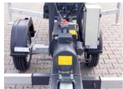
Einschiebbare Achse, Rangierbreite 0,89 m (optional)
