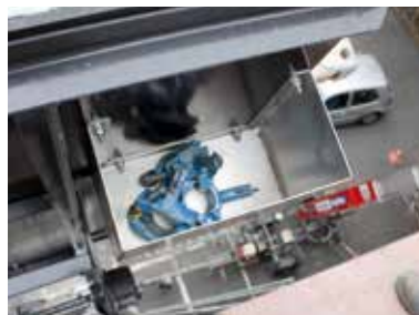
Pritsche ist mit Ablagefächern für Kleinteile ausgestattet
