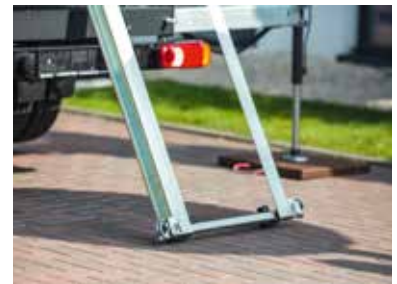
Bodentiefe Beladung möglich durch stufenlos ausziehbare untere Verlängerung
