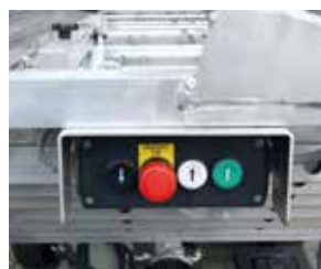
Elektrische Steuerung mit Schleichgang (optional)
