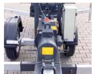
Einschiebbare Achse, Rangierbreite 0,89 m (optional)
