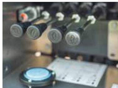
Steuerstand der hydraulischen Stützen
