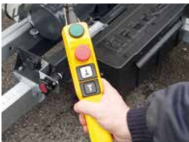
Elektrische Steuerung mit Schleichgang (optional)
