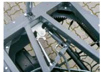
Optional mit hydraulischer Drehkranzverstellung
