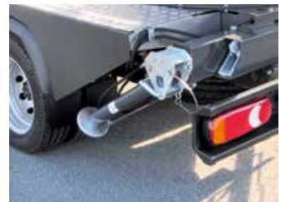
Hydraulische Stützen mechanisch ausziehbar und 60° schwenkbar
