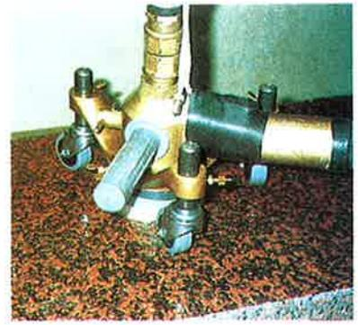
Blaskopffahrwerk für flächiges Strahlen, höhenverstellbar und leichtgängig z. B. für das Aufrauen eines Bodenbelages.
