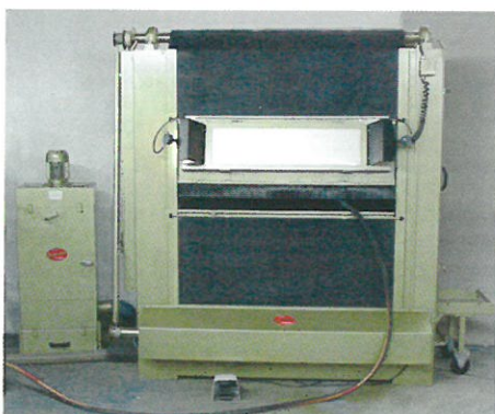
Strahlkabine „Futura“ mit teleskopierbarer Rollenbahn und verfahrbarem Vorhang zum Bearbeiten von tiefen Ornamenten und Schriften.
