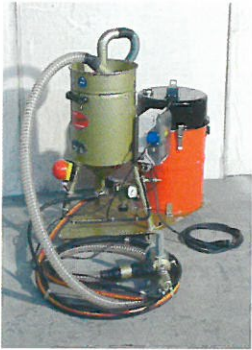
Staubfreier Injektor-Blaster TWS „K“ , leicht demontierbar, zum Anblasen von Schriften, Trittstufen etc.
