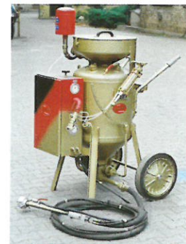
Power-Soft-Druckstrahlgebläse mit Feuchtnebel-Niederdruck, speziell für Restaurierungen, Sanierungen und Reinigung von Fassaden.
