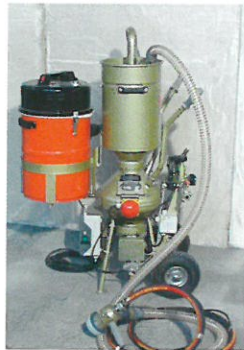
Staubfr. Druckstrahl-Blaster „DUPLO“ in tragbare Elemente leicht zerlegbar, für Zweitschriften und Baustelleneinsatz
