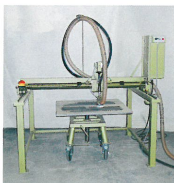
Strahlautomat BASM zum Automatisieren von Hand-Strahlgeräten.
