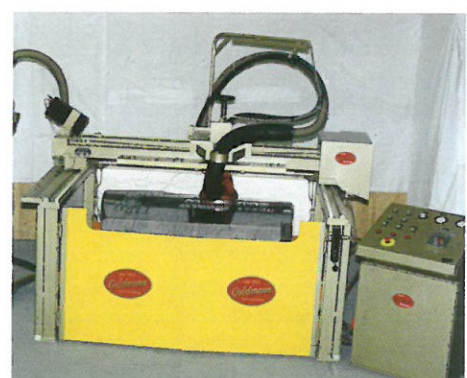
Brückenstrahlmaschine BSM 2001 / .. zum automatischen Strahlen von Schriften und Ornamenten, mit Mehrfeldsystem und vorwählbarer Strahltiefe
