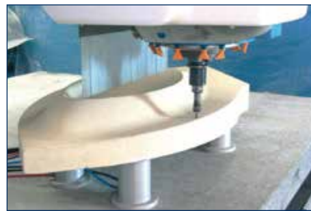
4 Machining of solid blocks Usinage dans la masse Massivwerkstück-Bearbeitung Trabajo en macizo
