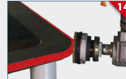
14 Polishing of convex edge Polissage de chant convexe Schleifen von konvexen Kanten Pulido de canto convexo
