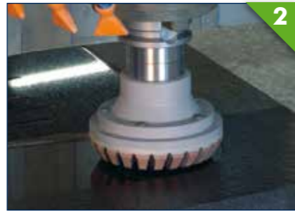
2 Drainboard polishing Polissage d'égouttoir Polieren von Abtropfflächen Pulido de escurrerplatos
