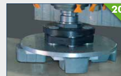
20 Marble flat polishing Polissage à plat de marbre Marmorflächen schleifen Pulido de mármol
