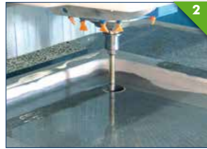
2 Vertical drilling on a shower tray Perçage vertical sur bac à douche Vertikale Bohrung auf einer Duschwanne Taladro vertical en un plato de ducha
