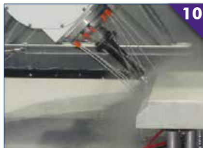
10 45° inclined milling Fraisage incliné à 45° 45° geneigtes Fräsen Fresado inclinado a 45°
