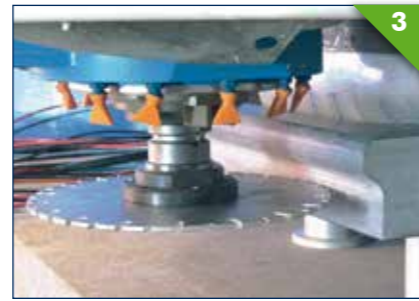
3 Horizontal sawing for shaping Sciage horizontal pour ébauche Horizontales Sägen Corte horizontal para desbaste
