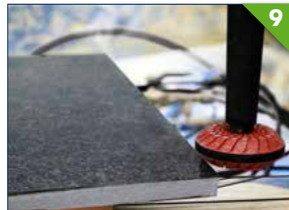
9 Upper or lower edge polishing Polissage d'arêtes supérieures ou inférieures Obere oder untere Fasen schleifen Pulido de arista superior o inferior
