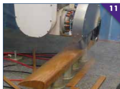
11 Quick shaping with disc Ébauche rapide avec disque Schnelle grobe Vorarbeit mit Sägeblatt Desbaste rápido con el disco
