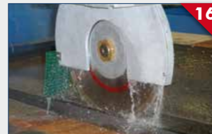
16 Straight sawing Sciage rectiligne Geradliniges Sägen mit Winkelgetriebe Aserrado rectilíneo
