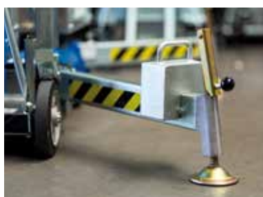
Mobile Kontergewichte für den Einsatz kürzerer Ausleger im Innenbereich (außer PHC-HI)
