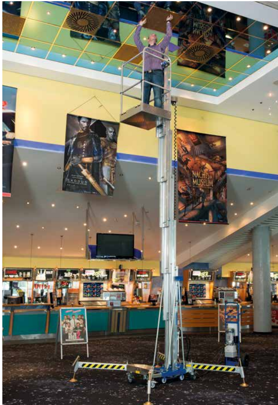
Für den Einsatz auf ebenen Flächen ist der Personen-Lift PHC 1000 EU um einen Adapter mit Auslegern erweiterbar.
