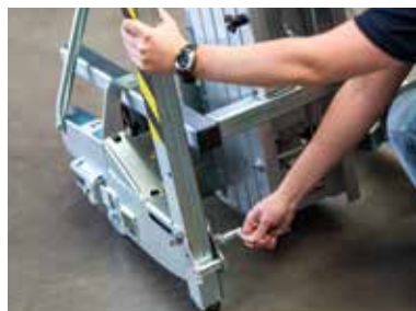
Öffnen und Fixieren der Vorderteile mittels Federriegel
