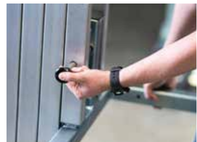
Montage und Fixierung der Lastgabel mittels Kugelsperrbolzen
