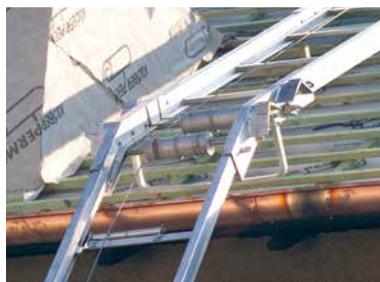
Integriertes oder mechanisch anbaubares Knickstück
