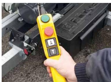
Elektrische Steuerung mit Schleifgang (optional)
