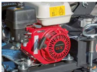
Antrieb über leistungsstarken Benzin- oder E-Motor
