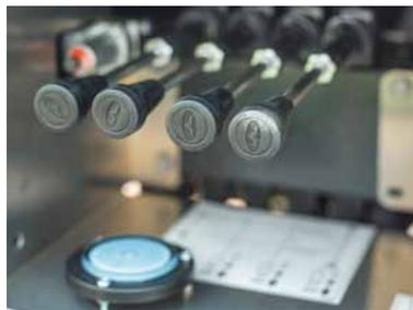
Steuerstand der hydraulischen Stützen
