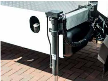
Hydraulische Stützen vorne optional ausziehbar
