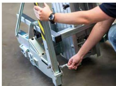
Öffnen und Fixieren der Vorderteile mittels Federriegel
