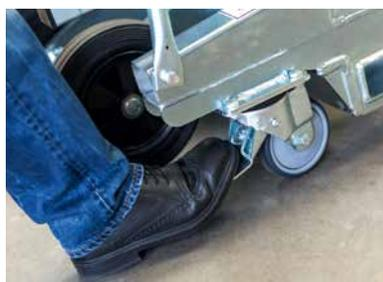
Fixierung der Feststellbremse an der Lenkrolle
