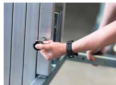
Montage und Fixierung der Lastgabel mittels Kugelsperrbolzen
